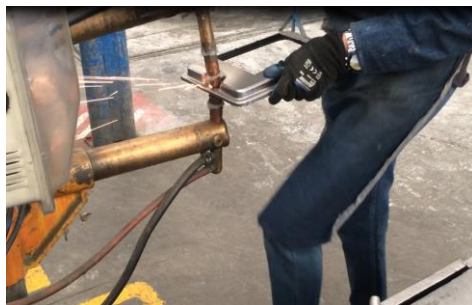
Figura 3-15. Soldadura de punto.
