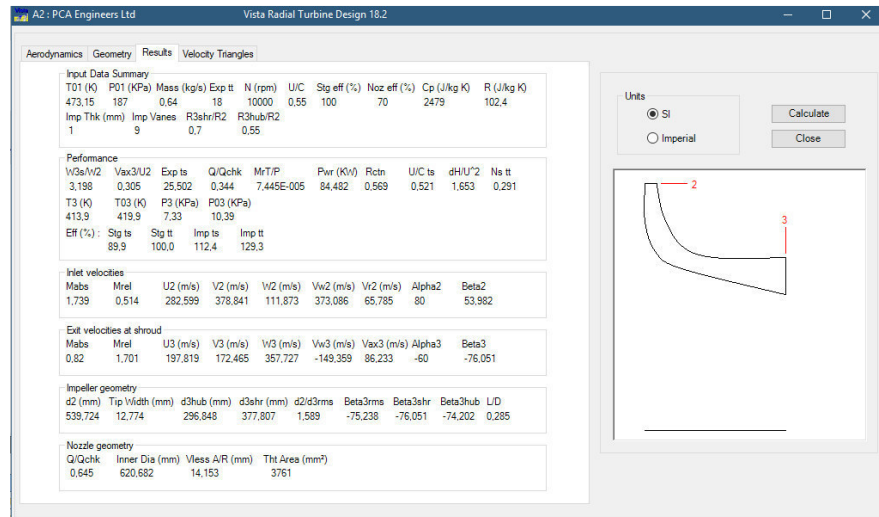
Fig. 25: Dimensionamiento de una turbina de flujo radial usando ANSYS-Vista RTD académico
