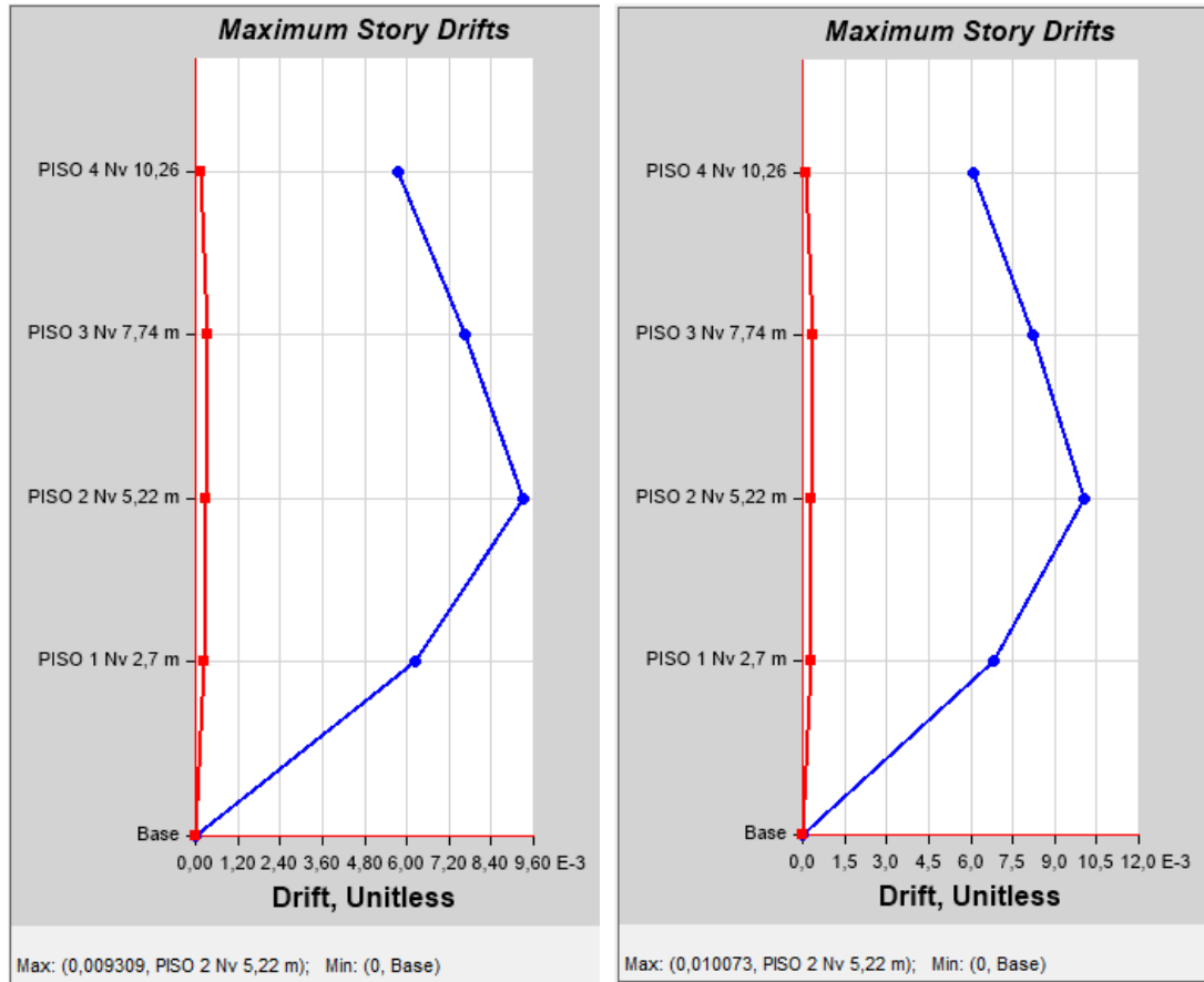
Figura 58. Derivas Elásticas obtenidas con el espectro de la NEC-15 y Espectro Específico para la estructura de 3 Piso - Sentido X
