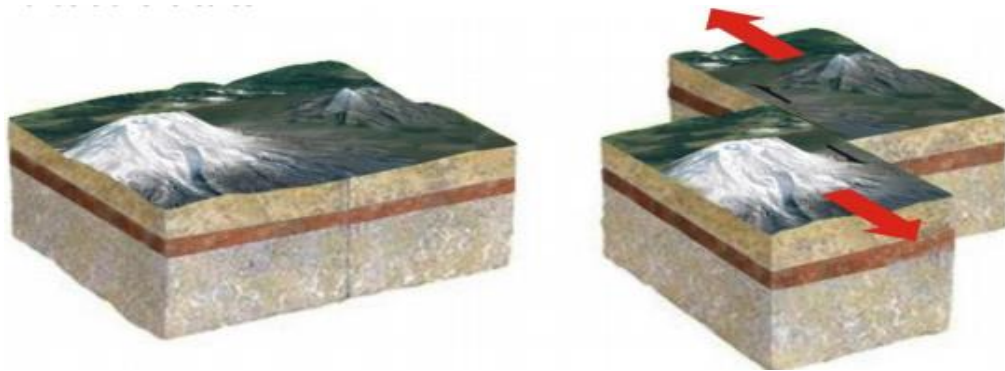
Figura 9. Falla de desgarre. La figura muestra como los bloques se deslizan lateralmente uno respecto al otro.
