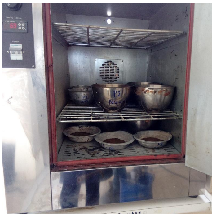
Fotografía 6. Secando las Muestras de Suelo
