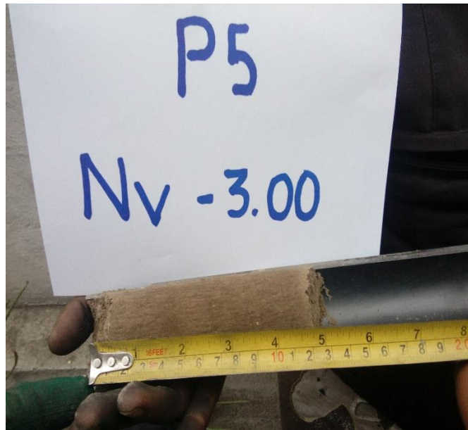
Fotografía 3. Midiendo la longitud de la muestra de suelo
