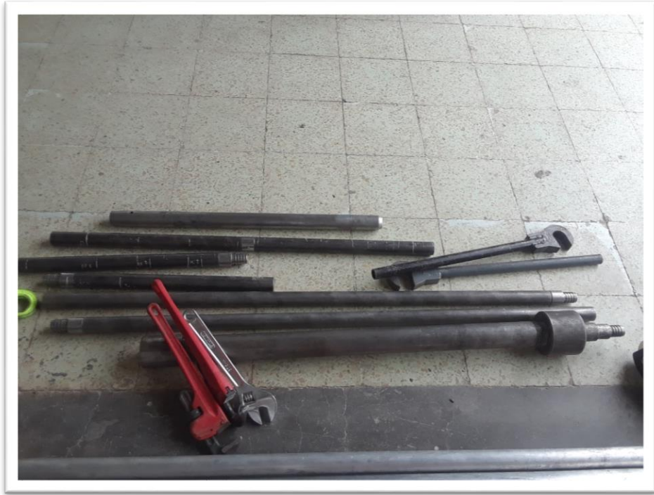
Fotografía# 1 equipo utilizado para realizar el ensayo de SPT.
