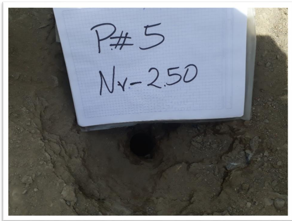
Fotografía# 7 numeración y profundidad del pozo ensayado.
