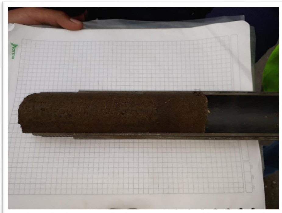
Fotografía# 6 muestra de suelo extraída tras realizar el ensayo de SPT.
