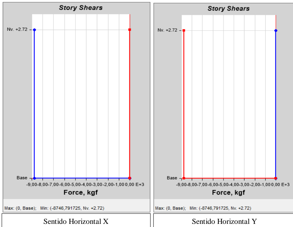
Figura# 35 Cortante estático en las direcciones X y Y para la estructura de un piso
