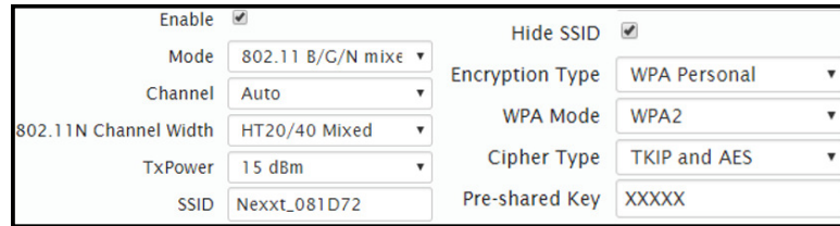
Figura 4.4: Configuración de la SSID, contraseña y potencia de transmisión de la red interna Wifi.
