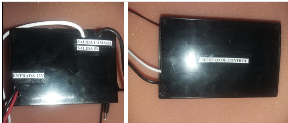
Figura 4.60: Vista externa del empaque del módulo de control.
