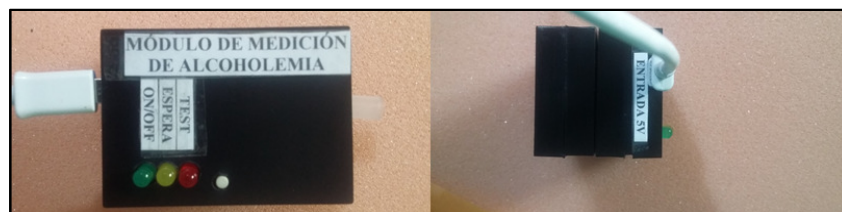
Figura 4.63: Vista externa del empaque del módulo de medición de alcoholemia.
