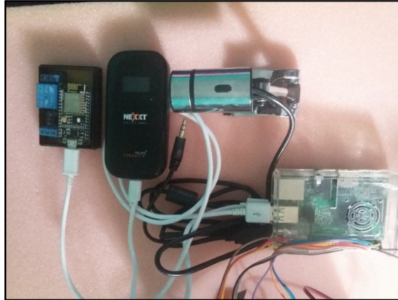
Figura 4.59: Conexión de dispositivos a los puertos USB de la RPI3.
