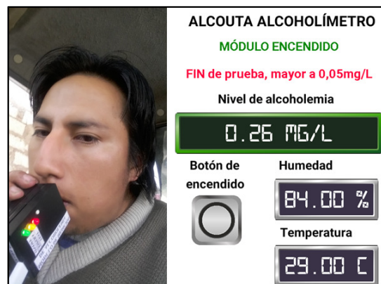
Figura 4.69: Indicadores de la finalización de la prueba de alcoholemia.
