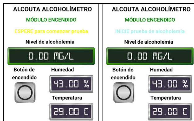
Figura 4.68: Mensajes informativos del módulo de medición de alcoholemia mediante virtuiino.
