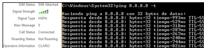
Figura 4.6: Verificación de conexión hacia la nube mediante comando ping y panel de router.
