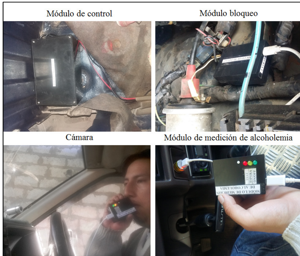
Figura 4.67: Implementación del prototipo en el vehículo.
