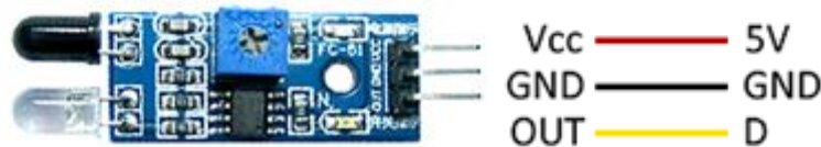
Figura 4.16: Módulo sensor de Infrarrojos IR FC-51 [21].
