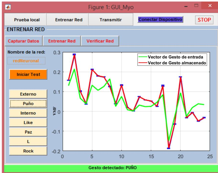
Fig. 6.47.b. Contraste entre los gestos adquiridos y los usados para el entrenamiento de la Red Neuronal Artificial – Puño
