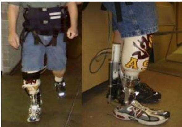
Fig. 2.8. Prótesis robótica.
