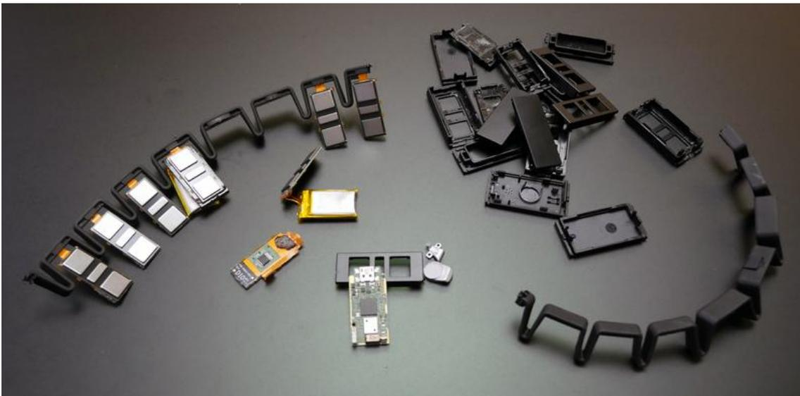
Fig. 6.1. Arquitectura interna del Myo Armband
