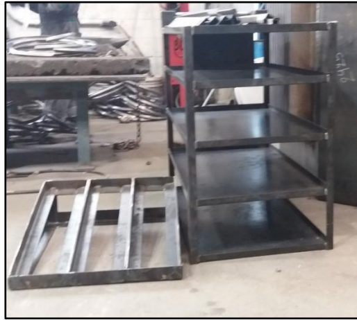
Fig. 79 Construcción estanterías en el área de Metalmecánica
