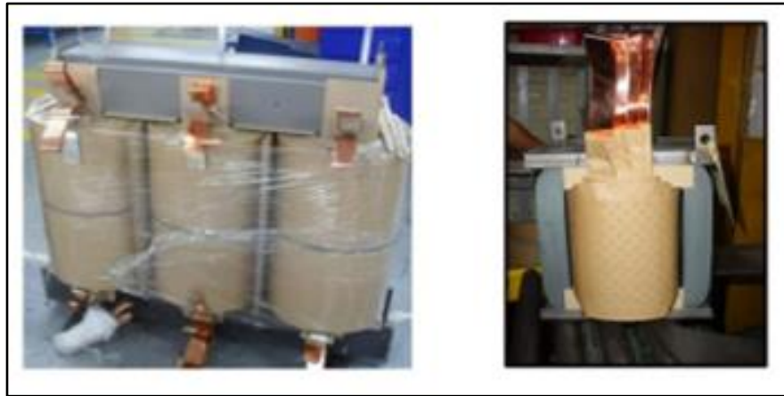
Fig.15 Ensamblaje parte activa, Núcleo – Bobina [18].
