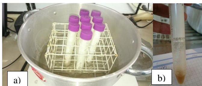
Figura 21. a) Muestras en incubación con \alpha -amilasa termoestable ( Bacillus licheniformis ), a temperatura de ebullición y una agitación a 400 rpm por 30 min. b) Muestra después de los 30 min de hidrólisis.
