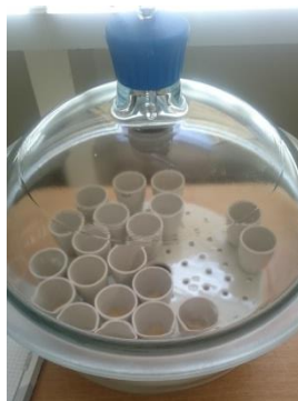
Figura 23. Enfriado de las capsulas de porcelana en un desecador por 30 min.
