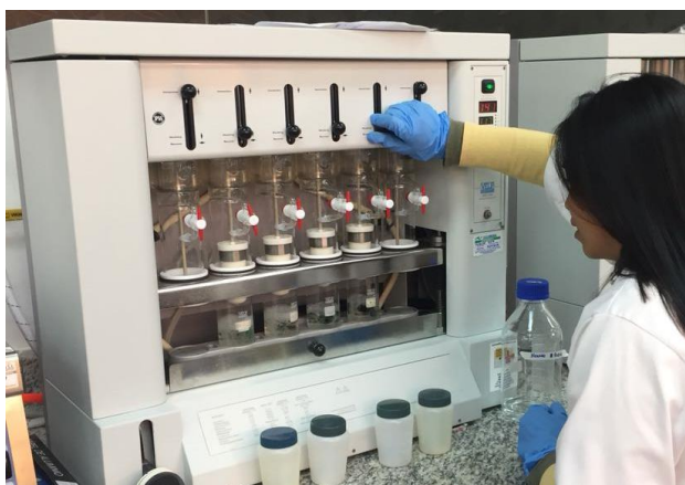
Figura 18. Colocación de las muestras en el equipo extractor de grasa con recuperación VELP SCIENTIFICA
