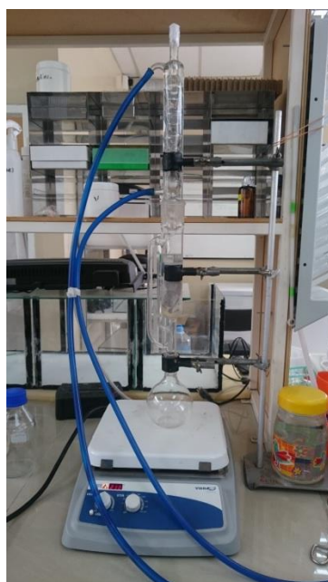
Figura 28. Extractor Soxhlet para grasa
