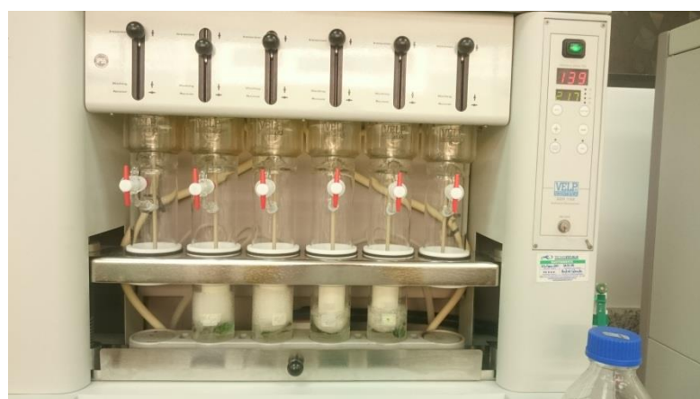
Figura 29. Extractor de grasa. (Método Golffish)
