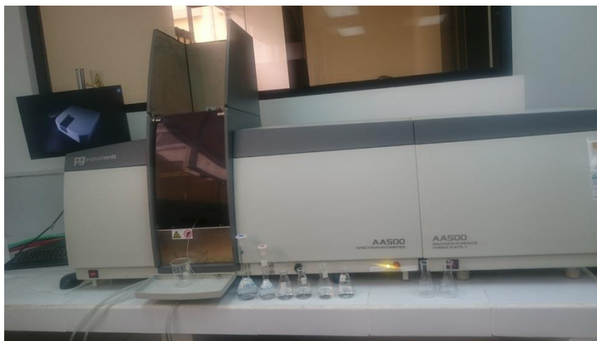
Figura. 24 Instrumento empleado. PG Instruments AA500
