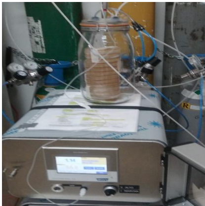
Inyección de \text{CO}_2 para generar anaerobiosis (análisis bacterias ácido lácticas)
