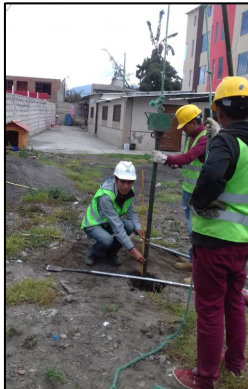
Fotografía 2. Medición cada 15 cm para el número de golpes
