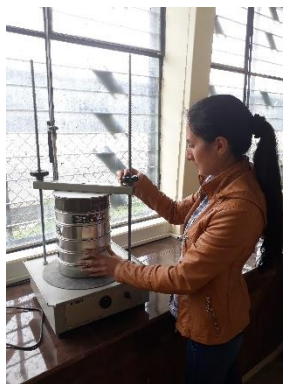
Fotografía 9. Tamización de la muestra
