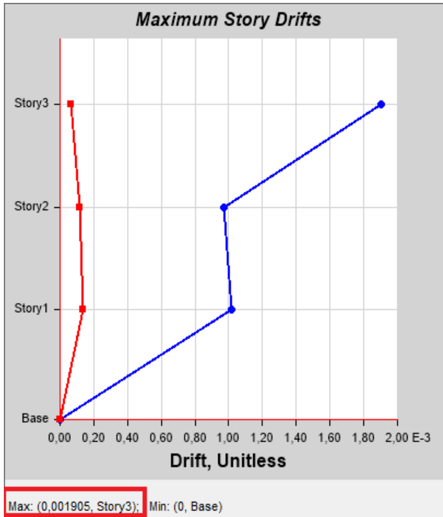
Gráfico N° 69 Deriva elástica estática en el sentido X Estructura de Tres Pisos - Espectro Determinista
