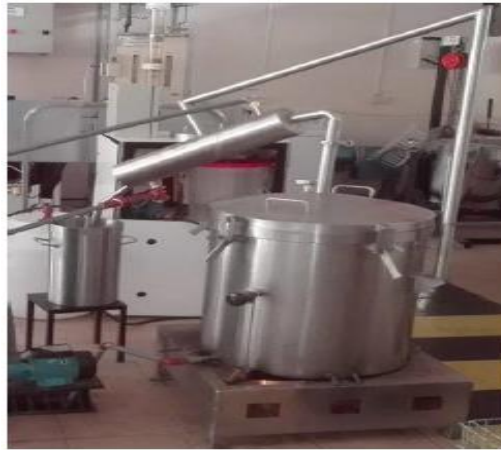
Anexo 1. Obtención del aceite esencial de canela, método de destilación por arrastre de vapor.
