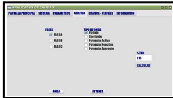
Figura 4-49 Valor de %THD del Voltaje para prueba con carga residencial (refrigeradora)
