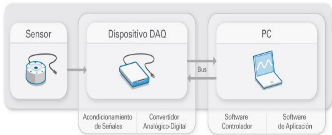
Figura 2-28 Partes de un sistema DAQ [35].
