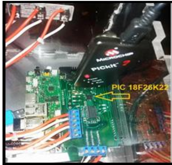
Figura 4-31 Programación del PIC 18F26K22
