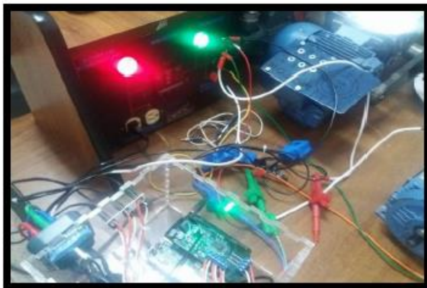
Figura 4-69 Equipo conectado a carga industrial (motor trifásico)
