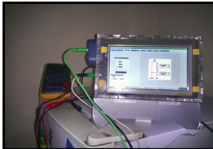
Figura 4-46 Equipo conectado a carga residencial (refrigeradora)
