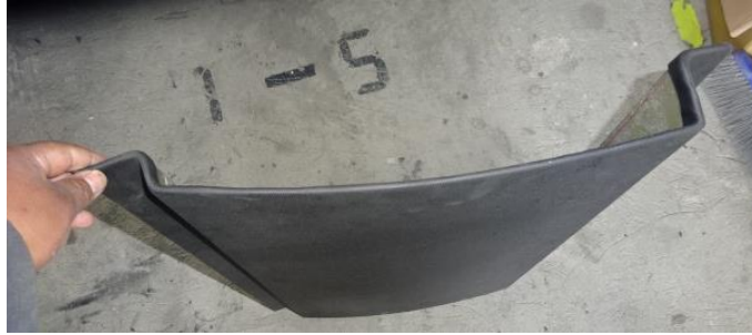
Figura 3-44: Desmoldado de piezas
