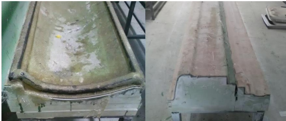
Figura 3-40: Fabricación de la matriz
