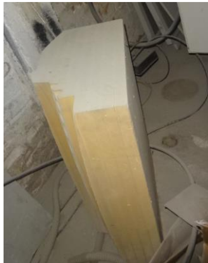
Figura 3-38: Molde mecanizado en madera
