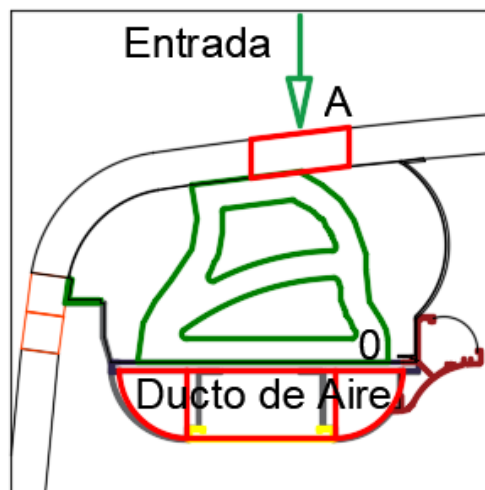
Figura 3-6: Ducto Porta paquete modelo operativo. Fuente: Autor
