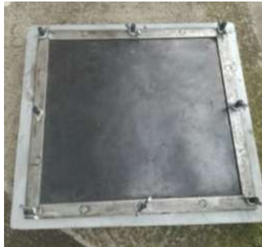
Fig. 3.4 Molde para elaboración de probetas (Fuente : Autor)
