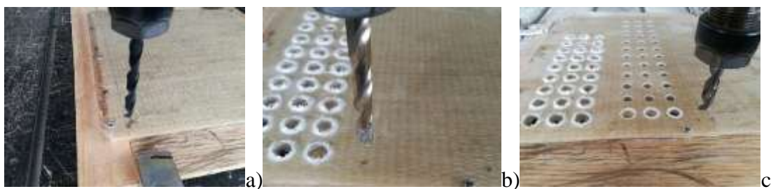
Fig. 3.6. Ensayos. a) Broca HSS, b) Broca con cubierta de diamante, c) Broca de carburo especial para kevlar
