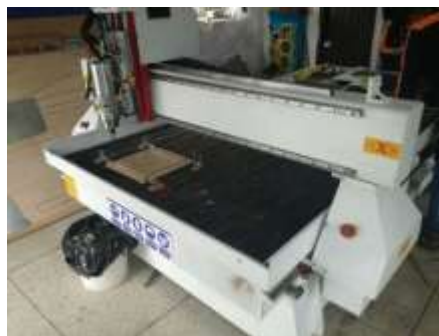
Fig. 3.5. Máquina CNC, SENFENG Modelo: 1325
