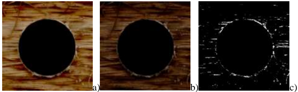
Fig. 3.9. Imagen digitalizada del agujero taladrado. A) imagen original, b) imagen mejorada en contraste al 50% y c) imagen en blanco y negro (Fuente : Autor)
