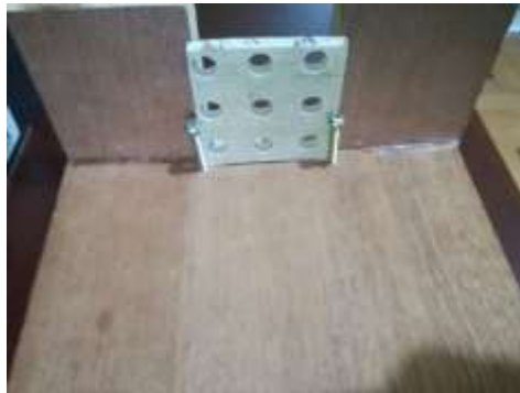
Fig. 3.7. Probeta sujeta para la medición de rugosidad (Fuente : Autor)
