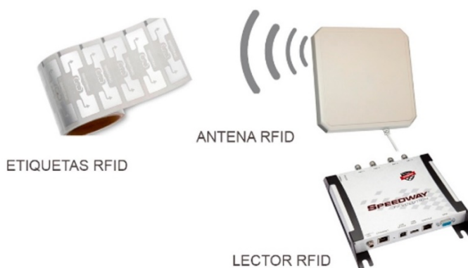
Figura 2 Componentes de un sistema RFID.
