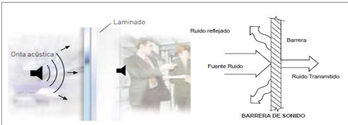
**Fig. 41.** Barreras de atenuación de ruido [37].
