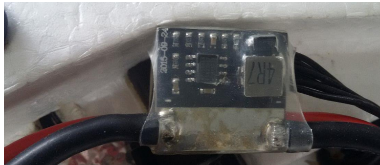
Fig. 4. 9 Dispositivo 3DR - ESC Fuente: Investigador.
