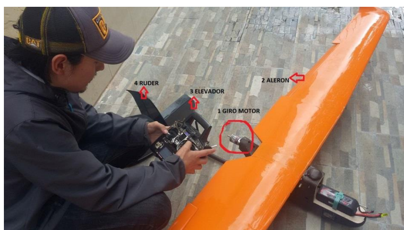
Fig. 4. 33 Control de velocidad de motor a través de señales PWM del autopiloto Pixhawk Fuente: Investigador
