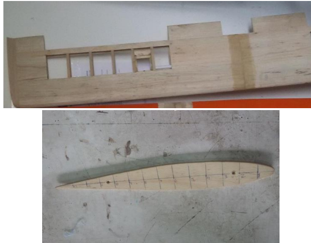
Fig. 2. 12 Ala Rectangular y tipo de perfil utilizado en el UAV Mini CIDFAE. Elaborado por: El investigador
