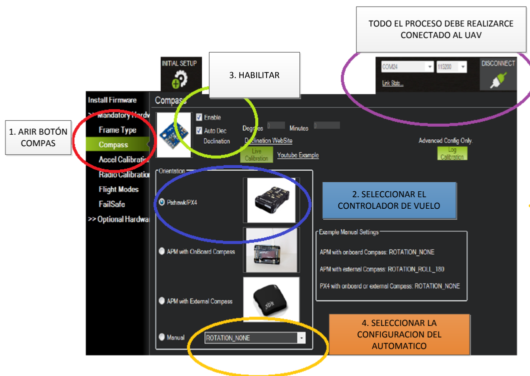
Fig. 4. 18 Calibración Brujula Fuente: Investigador.
