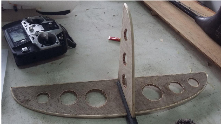
Fig. 4. 4 Forma de la cola en T reducido peso Fuente: Investigador.
