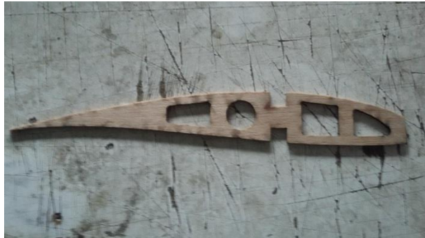
Fig. 4. 2 Forma del perfil mejorando para reducir peso Fuente: Investigador.
