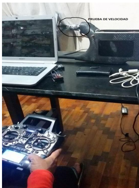
Fig. 4. 32 Prueba de control de velocidad de motor con receptor RC y ESC Fuente: Investigador
