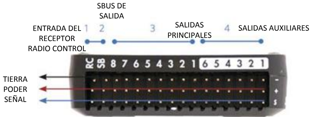
Fig. 4. 7 Diagrama Interno de del Pixhawk [48] Fuente: Investigador.
