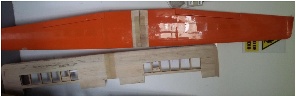
Fig. 4. 3 Forma recta aumentada su nivel de planeación (configuración del ala) Fuente: Investigador.
