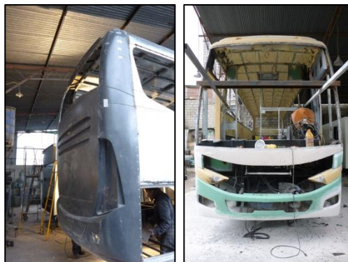
Fig. 22 Forrado exterior del respaldo y frente. Fuente: Carrocerías COPSA.
