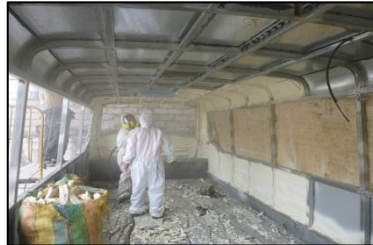
Fig. 23 Aplicación de poliuretano. Fuente: Carrocerías COPSA.
