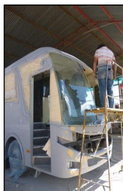
Fig. 28 Instalación de parabrisas. Fuente: Carrocerías COPSA.
