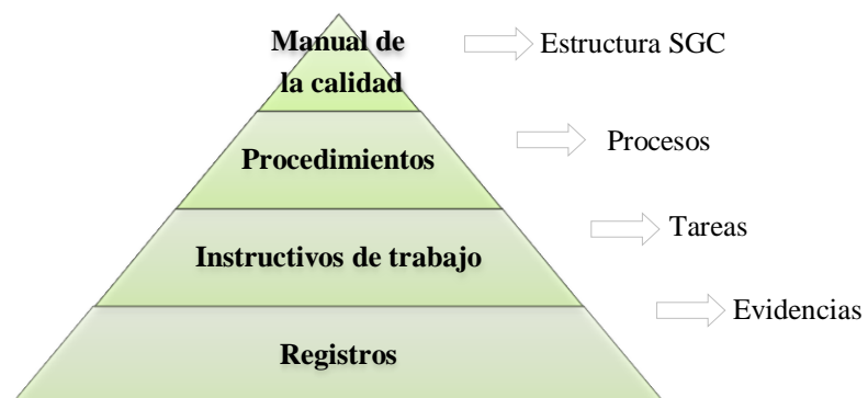
Fig. 4 Estructura documental basada en la norma ISO 9001:2015. Fuente: Diseño de un modelo de SGC con fundamento en las normas ISO 9001:2015 [23].
