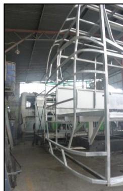
Fig. 19 Armado de estructura de respaldo. Fuente: Carrocerías COPSA.
