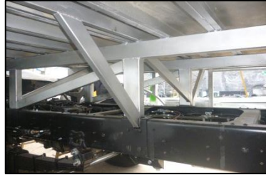
Fig. 14 Construcción del suplex. Fuente: Carrocerías COPSA.
