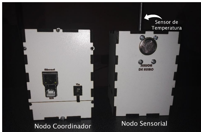
Figura 4.15 Prototipo terminado Nodos Coordinador y Sensorial en Case.
