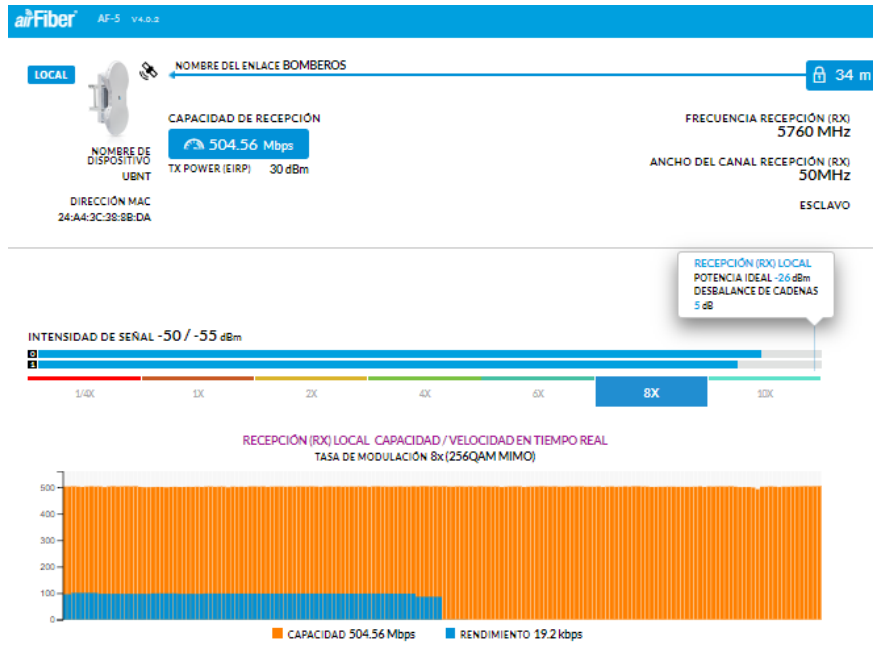
Figura 25 Capacidad del enlace en RX1 AirFiber 5 en laboratorio Elaborado por: Investigador
