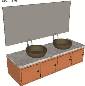
Lavamanos, mueble y espejo en baño de hombres Esc: s/e
