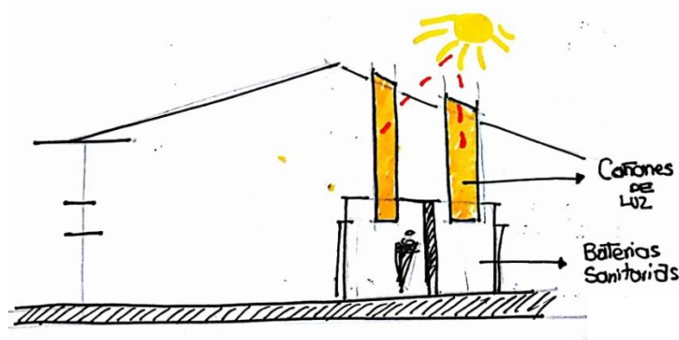
Gráfico No. 34 Ingreso de luz natural - baterías sanitarias
