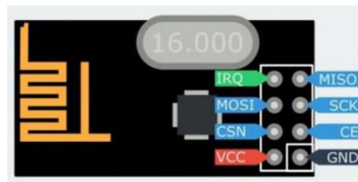
Figura 9: Distribución de pines del módulo nRF24I01.
