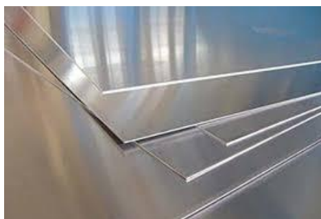
Figura 2.33.- plancha de aluminio liso de 3mm
