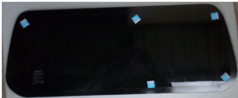
Figura 2.29.- Vidrio templado-parabrisas posterior Fuente: Anexo 2 (Norma NTE INEN 1669)
