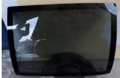
Figura 2.28.- Vidrio laminado-parabrisas frontal-cóncavo Fuente: Anexo 2 (Norma NTE INEN 1669)
