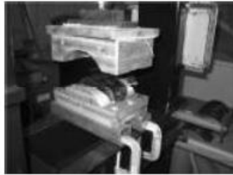
Figura 2.39.- Moldeo por compresión de pre impregnado de fibra de carbono.
