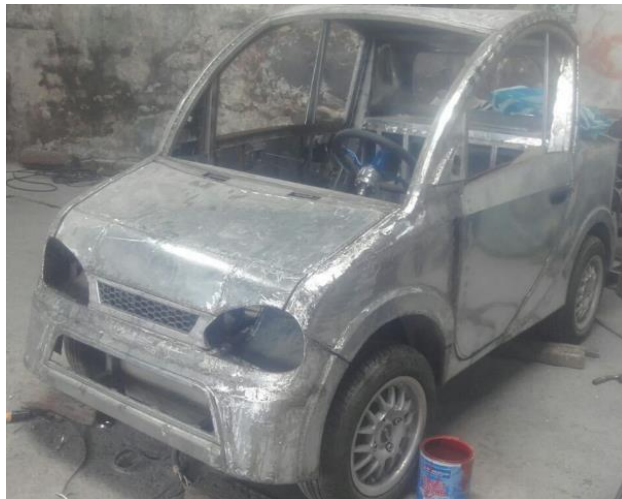
Figura 2.31.- Forrado exterior del CIM 2017(Planos)
