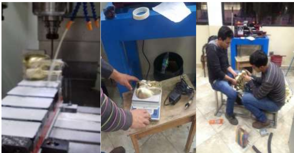
Figura 64. Fabricación y ensamblaje en el rodete de los álabes Fuente: autores
