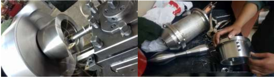
Figura 62. . Fabricación y ensamblaje del inyector Fuente: autores
