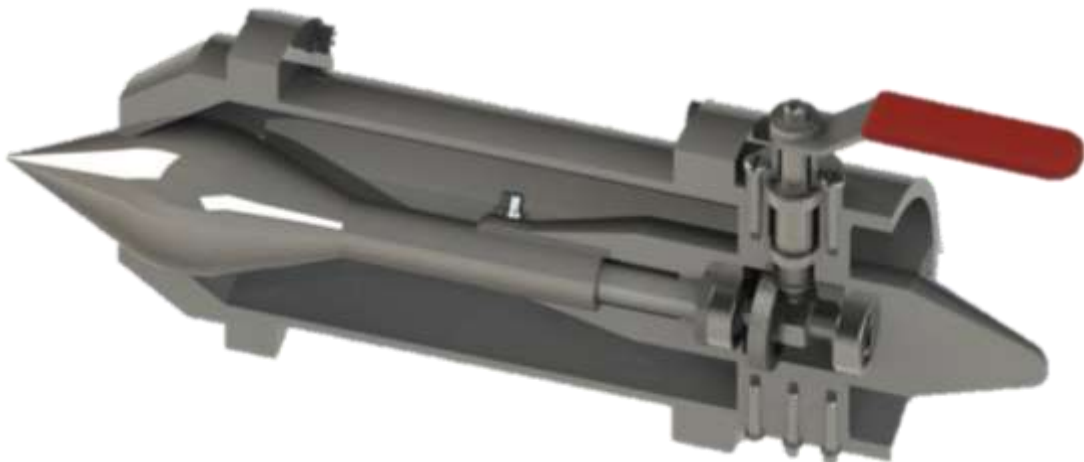
Figura 35. Parte interna del inyector Fuente: autores
