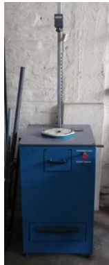
Figura 3.16 Máquina para ensayo de impacto tipo dardo laboratorio FICM – UTA.
