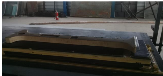
Figura 3.4 Molde ubicado sobre la mesa de termoformado.
