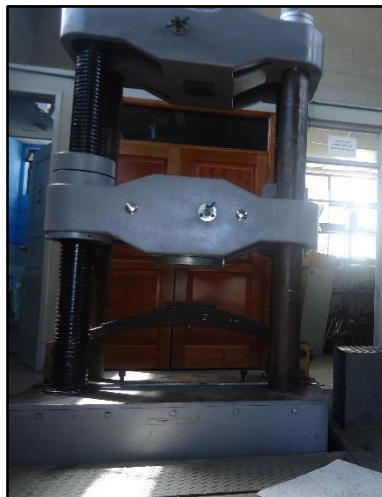
Fig. 18. Maquina ensayo flexión de paquetes diferentes condiciones de trabajo. (Fuente: Autor)
