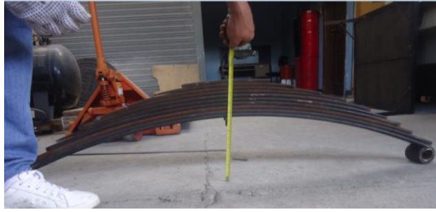
Fig. 16. Control de la altura de flecha requerida. (Fuente: Autor)
