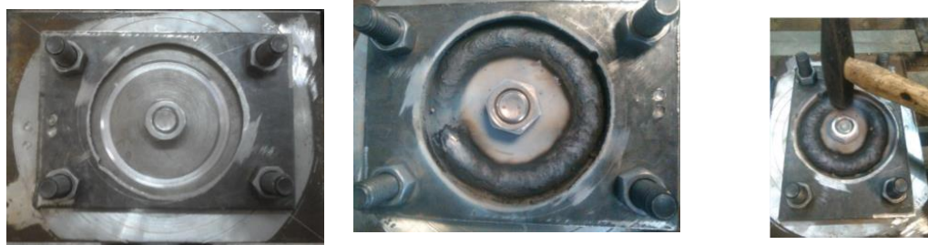
(a) (b) (c) Figura 21. (a) Matriz con probeta acanalada, (b) Probeta soldada en matriz para evitar pandeo, (c) Martillado post-soldadura para aliviar tensiones.
