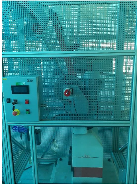
Figura 35. Equipo para ensayo de impacto. Fuente. Autor
