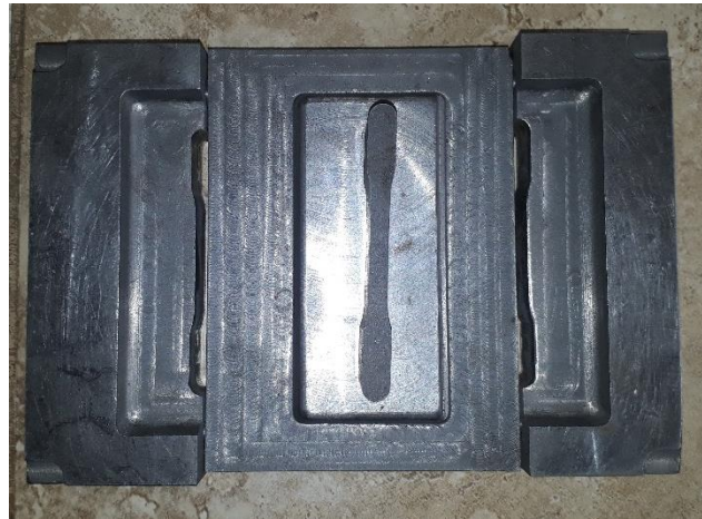
Figura 29. Molde para prensado de probetas. Fuente. Autor
