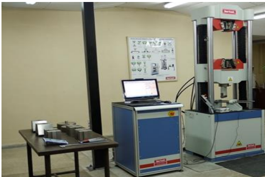
Figura 12. Equipo para ensayo de tracción. Fuente. [21]
