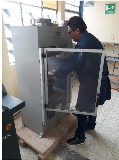
Figura 28. Proceso de compactación en la prensa universal Fuente. Autor
