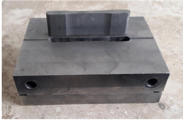
Figura 30. Molde para prensado de probetas. Fuente. Autor
