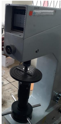
Figura 34. Equipo para medición de dureza. Fuente. Autor
