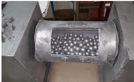
Figura 20. Molino de bolas Fuente. Autor
