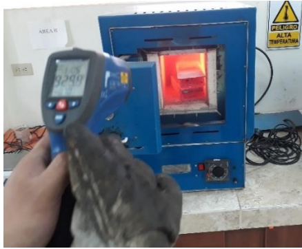
Figura 32. Proceso de sinterizado. Fuente. Autor
