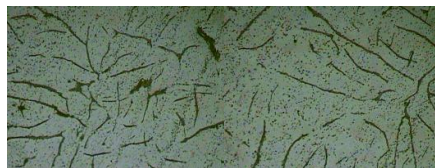
Hierro fundido gris a 100X, Nital 2%, 3 seg.
