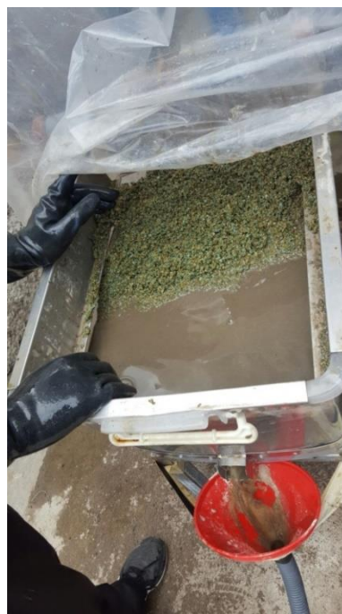
IMAGEN 6. Saturación de lodo en el Material Filtrante
