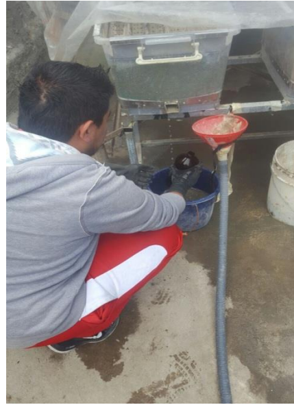
IMAGEN 10. Toma de Muestras Agua Filtrada
