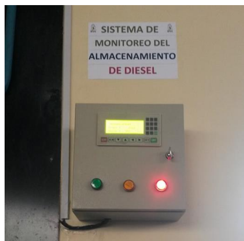
Figura 4.70: Prototipo completo del sistema de monitoreo de níveles de diesel
