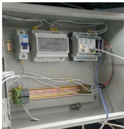
Figura 4.57: Colocación los elementos en el riel din
