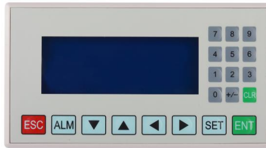
Figura 2.17: Pantalla HMI (Interfaz Humano-Máquina) [23] [24]
