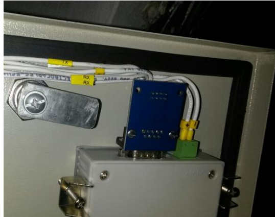
Figura 4.58: Conexión MAX3232 y alimentación a la pantalla OP320-A Elaborado por: Oscar Analuisa
