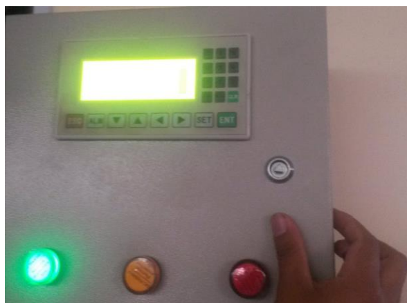
Figura 4.61: Panel frontal instaladas las tres luces indicadoras Elaborado por: Oscar Analuisa
