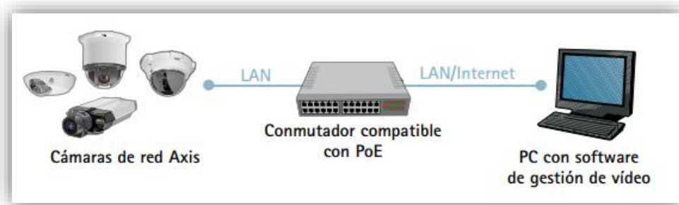
Figura 2.16: Sistema de vídeo en red con transmisión continua a través de una red IP [29]
