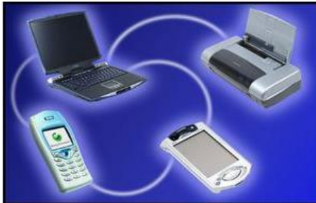
Figura 2.4: Ejemplo de una red tipo PAN [17]
