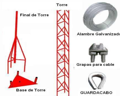
Figura 4.24: Torre para los Radio Enlaces
