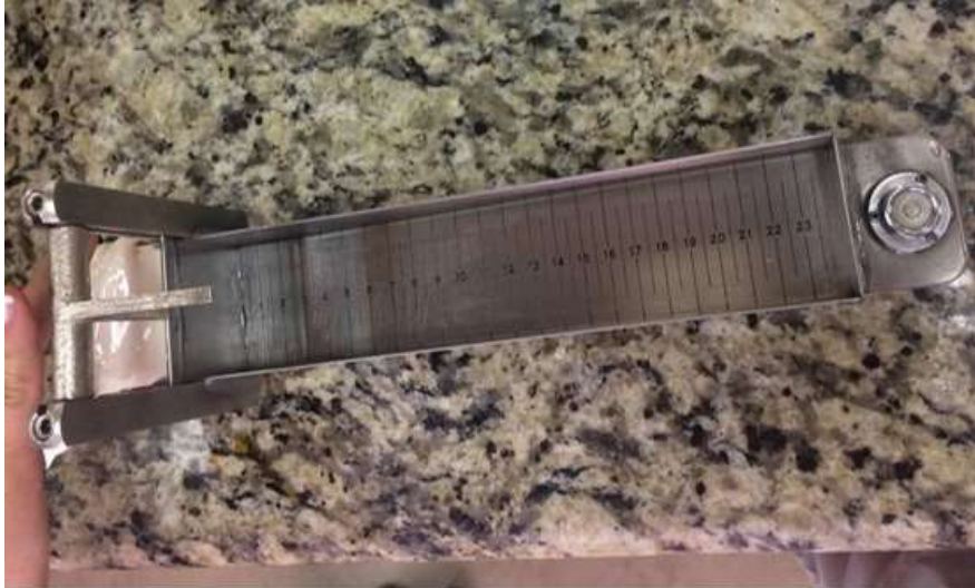
Figura G1. Medición de la consistencia de la masa del mejor tratamiento
