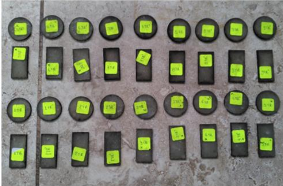
Figura 3-19. Cortes láser reales de probetas del compuesto tradicional. Fuente: Autor
