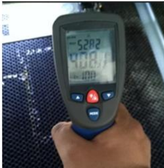
Figura 3-31. Medición de la temperatura superficial con el pirómetro. Fuente: Autor
