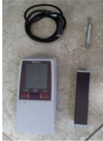
Figura 3-24. Rugosímetro MITUTOYO SJ 210. Fuente: Autor
