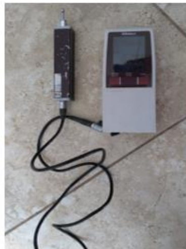
Figura 3-25. Rugosímetro ensamblado. Fuente: Autor
