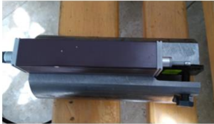
Figura 3-29. Ubicación de probeta y rugosímetro. Fuente: Autor
