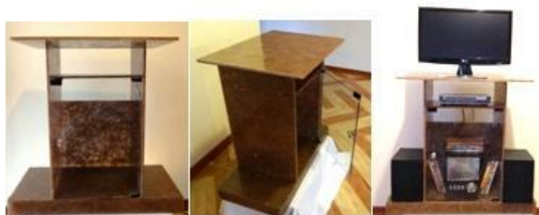
Figura 4.32. Muebles para dispositivos audiovisuales de compuesto poliéster/ fibra natural [23].
