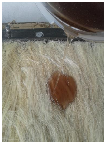
Figura 4.19. Colocación de la resina en el molde.
