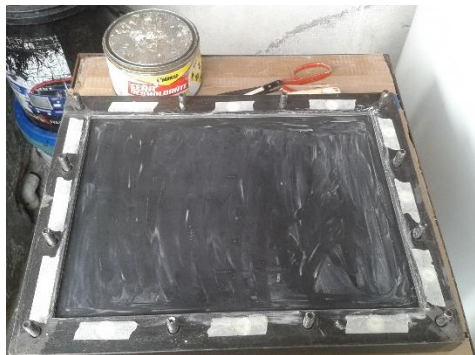
Figura 4.14. Aplicación de cera desmoldante.
