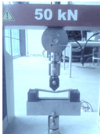
Figura 4.22. Ensayo a Flexión según la norma ASTM D7264-15.
