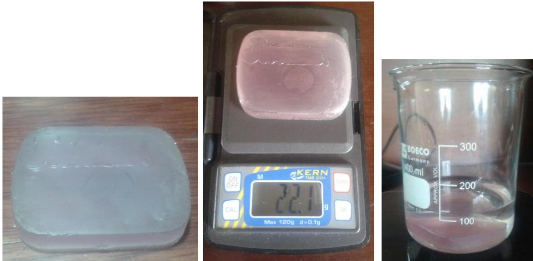
Figura 4.11. Determinación de la densidad de la resina poliéster.
