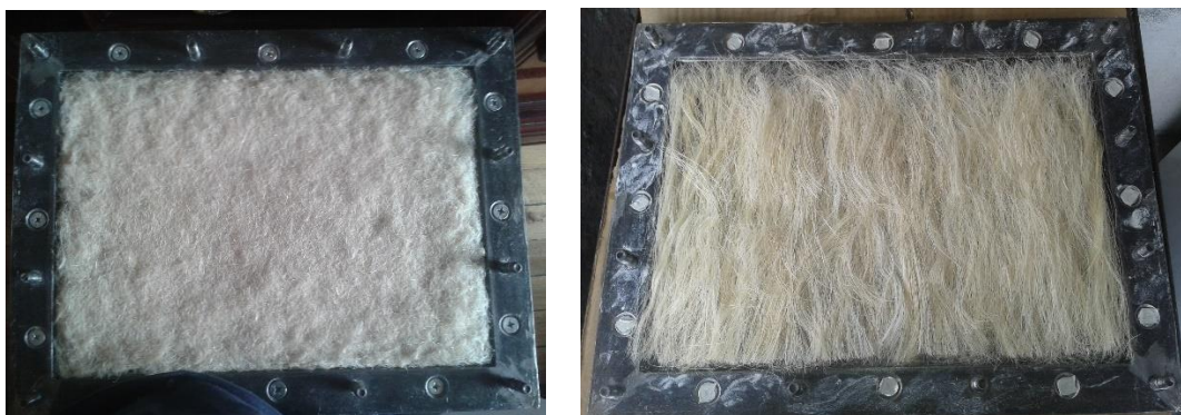
Figura 4.17. Colocación de la fibra vegetal.
