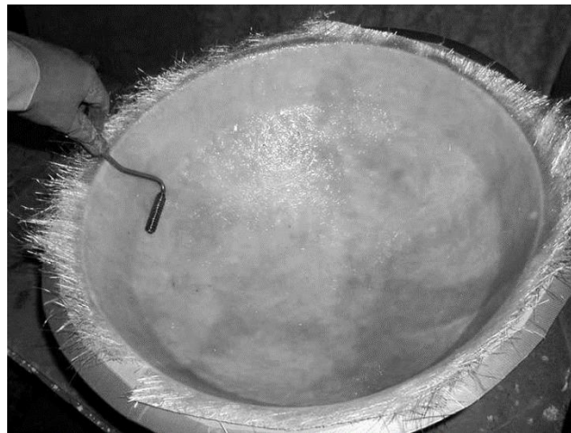
Figura 2.11. Fabricación de un domo de matriz poliéster reforzado con fibra de vidrio mediante estratificación manual.
