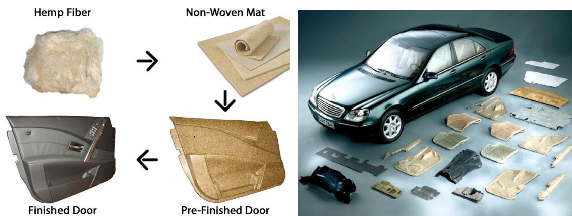
Figura 4.29. Aplicaciones de materiales compuestos reforzados con fibra natural en la industria automotriz [20].
