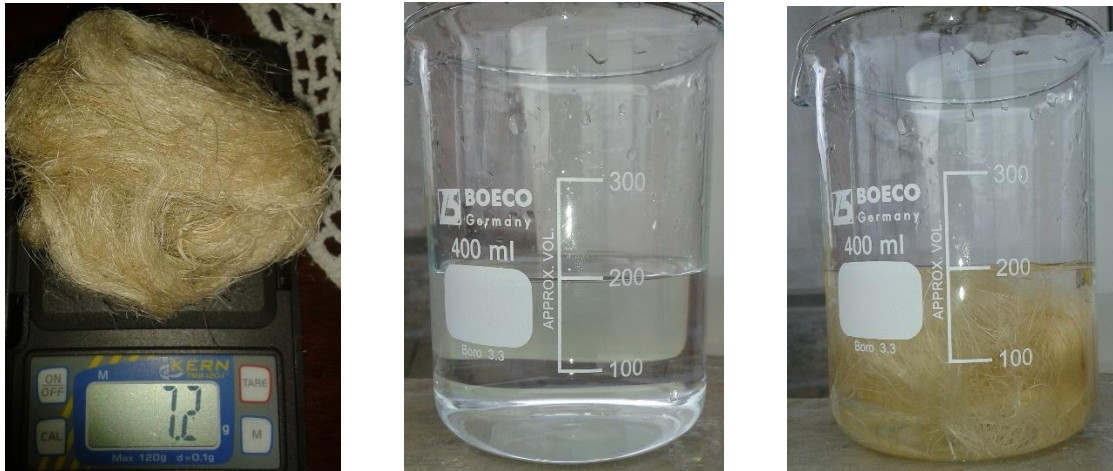
Figura 4.12. Determinación de la densidad de la fibra de hoja de Yucca Elephantipes.
