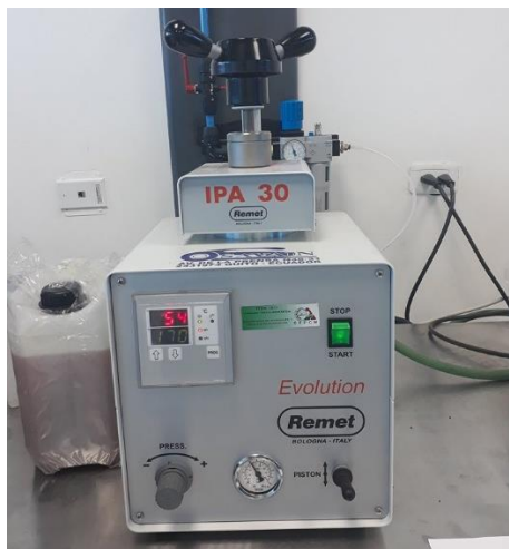
Figura 3.10 Prensa metalográfica Fuente: Autor
