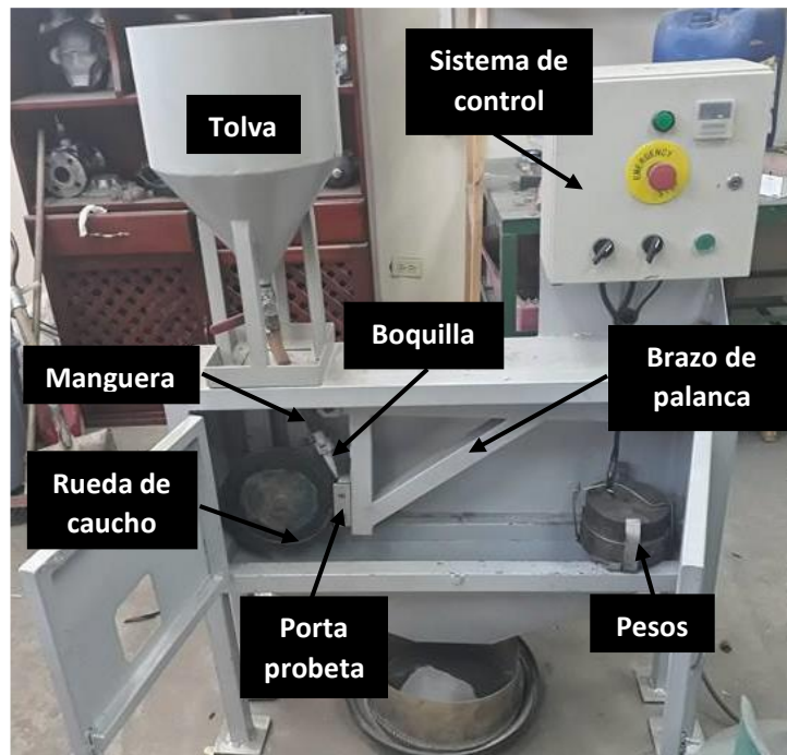
Figura 3.6 Partes de la máquina para ensayo de desgaste abrasivo bajo la norma ASTM G-65 Fuente: Autor
