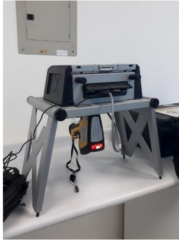
Figura 3.13 Espectrómetro OLYMPUS DPO2000-C Fuente: Autor
