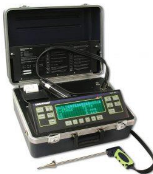
Figura. 4 Analizador de Combustión Ambiental 450 de Bacharach
