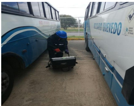
Figura. 24 Medición de GEI con el equipo ECA 450
