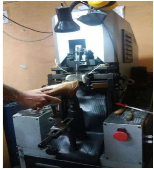
Armadora de puntas
