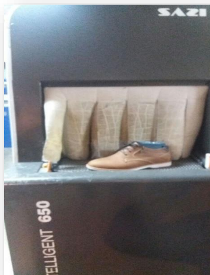
Túnel de frío
