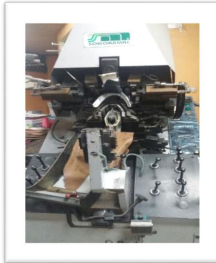
Armadura de puntas
