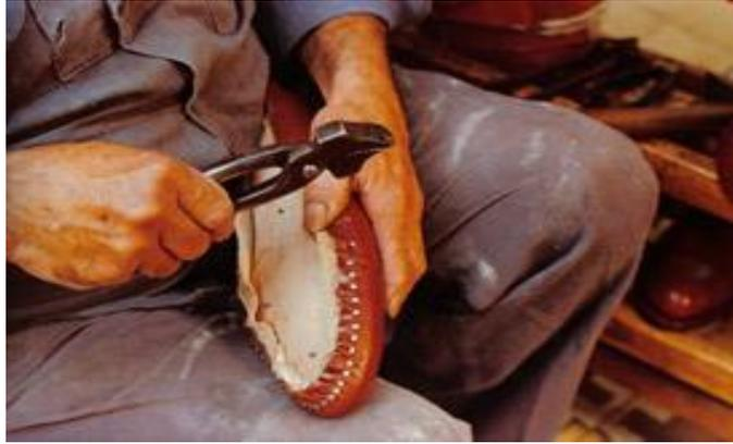
Figura 2- 4. Armado de calzado [4]
