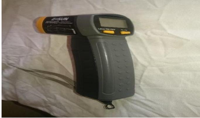
**Figura 3- 4.** Pirómetro digital
