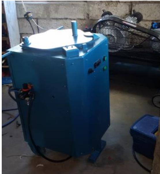
**Figura 1-1.** Máquina pegadora de compresión neumática
