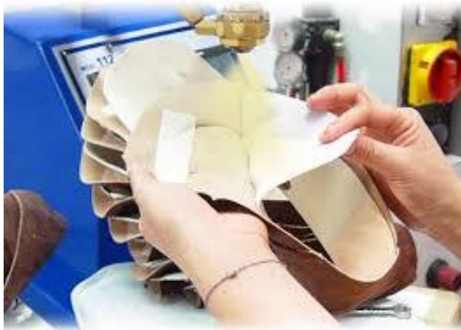
Figura 2- 5. Colocación del adhesivo en el corte [5]
