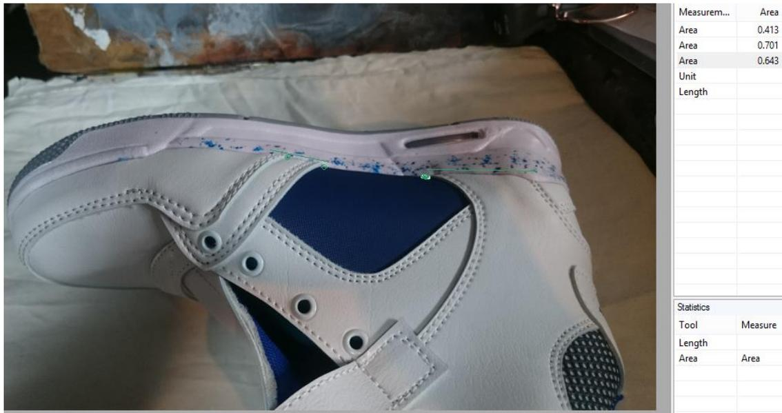
**Figura 4- 7.** Análisis de la parte L.I del calzado JORDAN a 54 PSI Y 10 segundos
