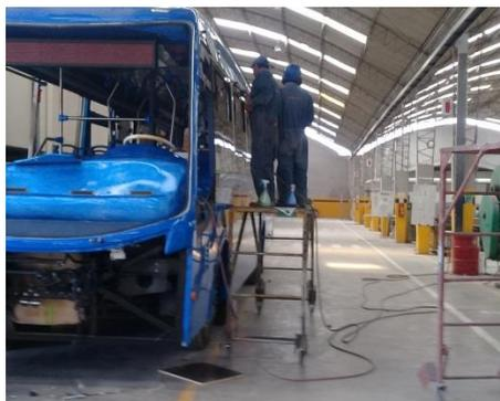
**Figura 20.** Colocación de complementos, ventanas y parabrisas.
