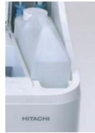
5. Destapar los frascos de ProCell y CleanCell, los cuales se encuentran en el siguiente orden de izquierda a derecha: PC2-CC2-PC1-CC1 (Se debe cambiar el orden de los reactivos cuando PC1-CC1 estén en un nivel bajo, lo cambiamos en la posición de PC2-CC2, para esto el equipo debe estar encendido y en Standby, se procede a realizar escaneo de reactivos después del proceso).
