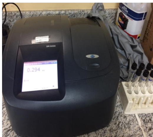
Fig N° 9. Medición de absorbancia del extracto para polifenoles
