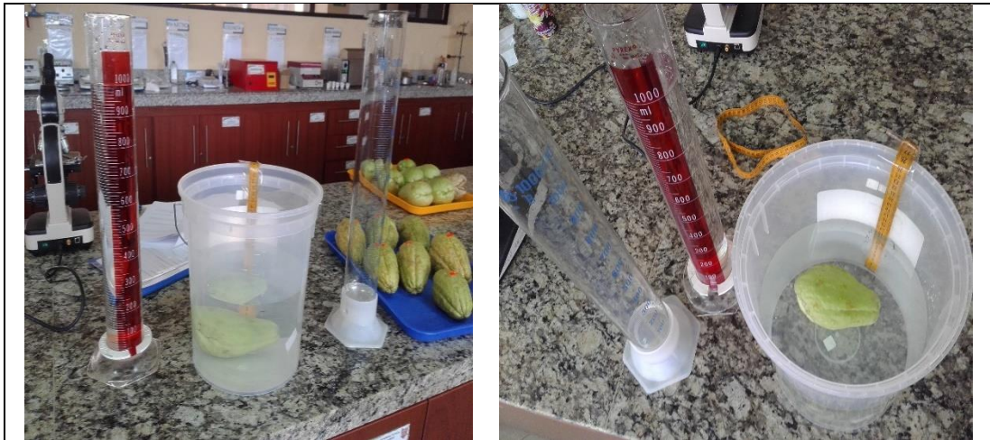
Determinación de volumen y densidad
