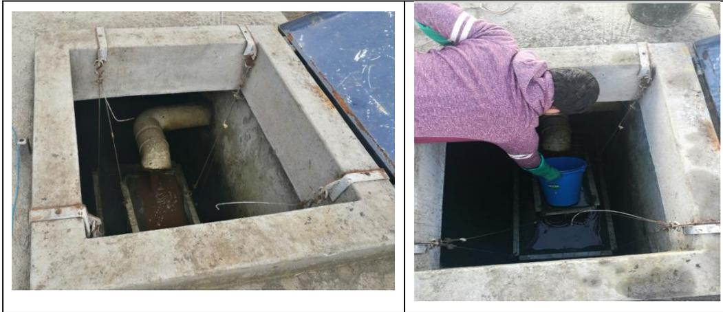
**Fig. 9.** Medición de caudal de salida del camal.
