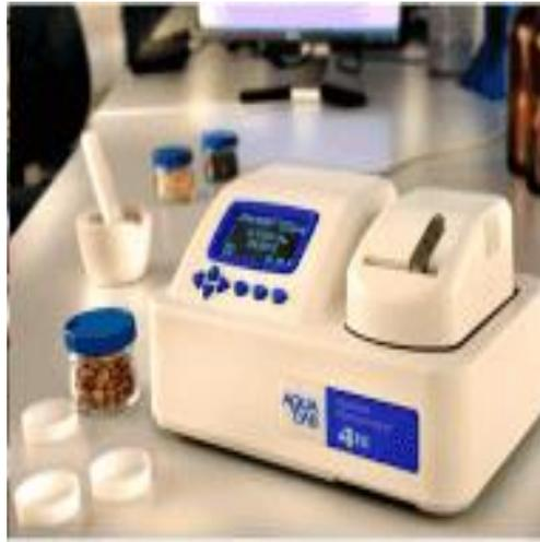
**Figura A4.** Equipo AQUALAB usado para la determinación de  $a_w$ .
