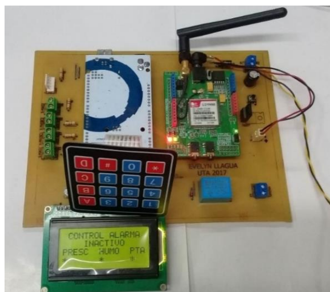
Figura 4.22: Implementación de la Central de alarmas en PCB.
