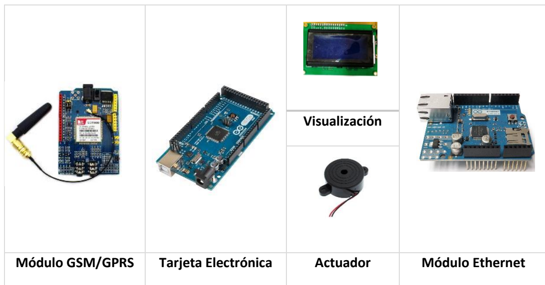
Figura 4.23: Elementos de la central de monitoreo
