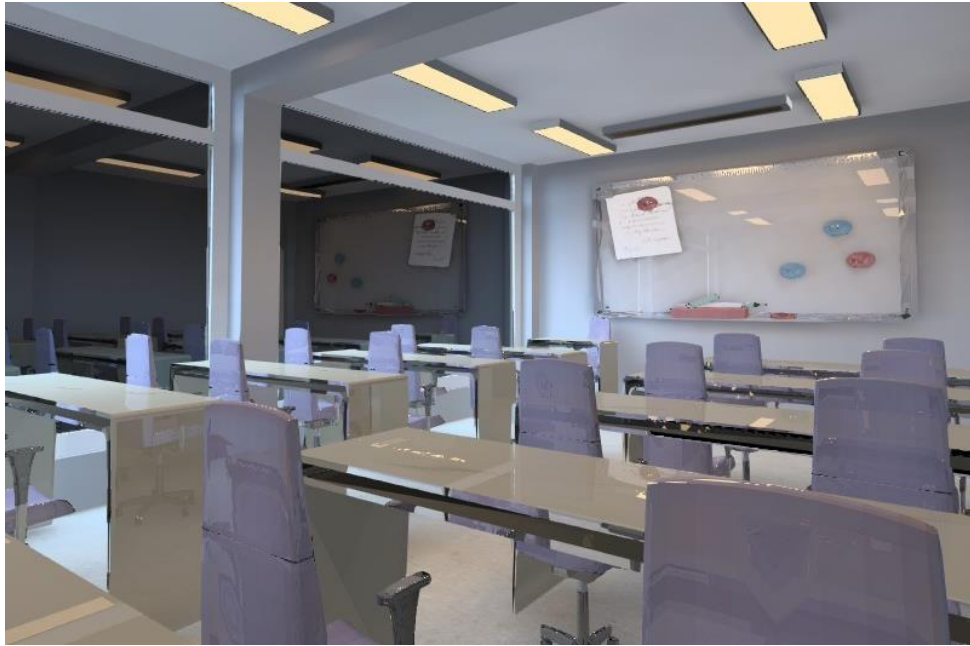
Figura 32. Vista de la sección frontal del aula modelo. Se identifica la disposición de las lámparas de forma longitudinal, y una lámpara para iluminación vertical de la pizarra.
