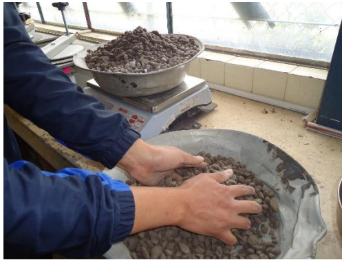
Pesando en la balanza electrónica el material para ensayo de Granulometría.
