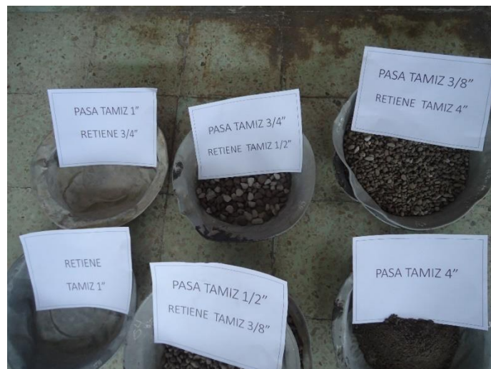
Ilustración 6. Material piedra Pómez tamizada.
