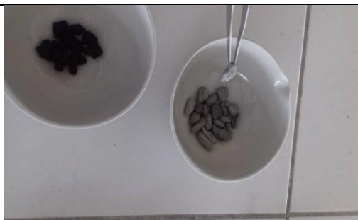
Material filtrante piedra Pómez, antes de ser usada y después de ser usada; como se puede observar en la imagen la piedra Pómez usada tiene un color negro intenso.
