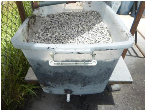
EL material filtrante piedra Pómez, colocado en el contenedor, listo para dar inicio el proceso de filtrado.
