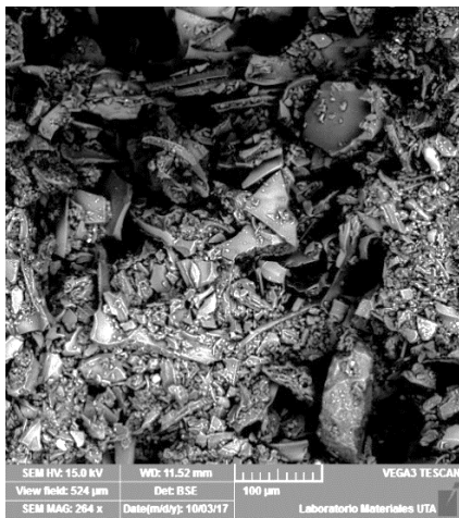
A. Material piedra Pómez Usada observado con un aumento de 264 x.
