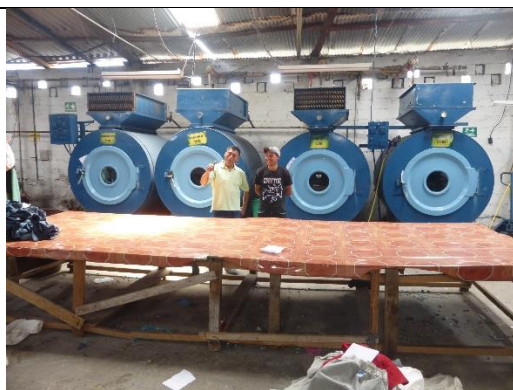
Máquinas de enjuague, a cada una de las máquinas se las coloca prendas del mismo color para su respectivo enjuague.
