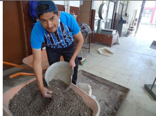
Material seleccionado con el tamaño de partícula adecuado, para los 35 litros necesarios para colocar en el contenedor del material filtrante.
